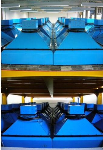
2005年12月に拡張されたブラジル宇宙線計。1 平米の検出面積をもつプラスチック・シンチレータ 28 台が上下 2 層にそれぞれ設置されており、間に 5cm 厚の鉛層が敷かれています。
