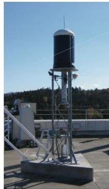
赤外線フーリエ分光計(左上)と太陽追尾装置(右上)。太陽を光源として、大気中の分子の吸収スペクトルを測定し、大気中の微量成分の濃度や高度分布を調べることができます。本装置の波長の分解能は、世界最高水準の  $0.0035 \text{ cm}^{-1}$  を誇り、30分で1セットのデータを取得できます。
