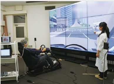
超大型（165 インチ）6 Kディスプレイで、ドライビングシミュレーターを操縦している様子 （脳波、心拍、血圧、心拍出量、皮膚抵抗値、筋電など、10種類の生理反応を測定しながら運転時の心理・生理反応を調べる） A virtual reality experiment with multiple physiological responses (EEG, Hear Rate, Blood Pressure, EMG, Skin Conductance Resistance etc.) being recorded in front of the large 6 K monitor (165 inch).
