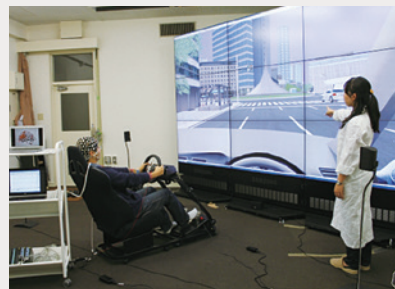
超大型（165 インチ）6 Kディスプレイで、ドライビングシミュレーターを操作している様子 （脳波、心拍、血圧、心拍出量、皮膚抵抗値、筋電など、10種類の生理反応を測定しながら運転時の心理・生理反応を調べる） A virtual reality experiment with multiple physiological responses (EEG, Hear Rate, Blood Pressure, EMG, Skin Conductance Resistance etc.) being recorded in front of the large 6 K monitor (165 inch).
